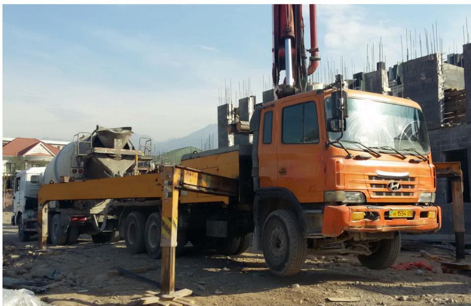
**Рисунок 15 – Общий вид автобетоносмесителя и автобетононасоса в работе**
