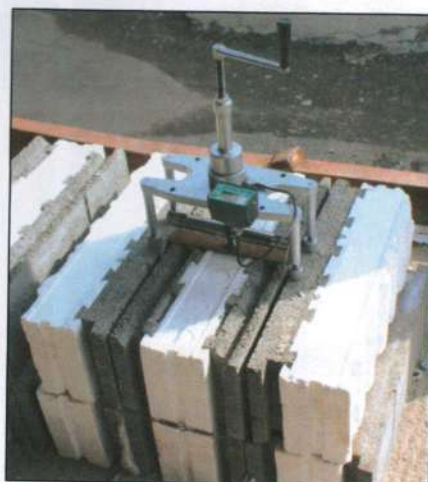
Рисунок 2.1 Определение сопротивлений кладки из трехслойных блоков «UNI» осевому растяжению по неперевязанным швам
